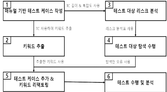
그림 4. 키워드 기반 탐색적 테스트 프로세스
